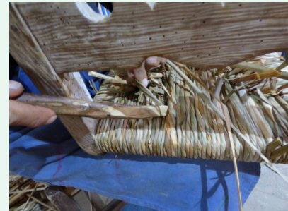
10. Un cop el teixit és acabat s'encoixina per sota amb l'ajuda de l'espasa, tot omplint de fulla de balca l'espai buit que encara ha quedat al mig.
