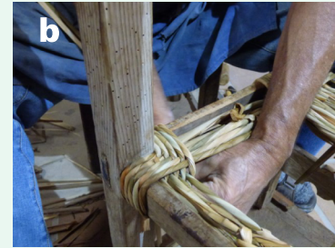
7. En aquest cas li donarem la forma anomenada «en davantal»: la part de davant és més llarga que la de darrere, així el seient serà més còmode i valent. Per aconseguir-ho, a la part de davant passarem cordill travesser cada quatre passades (a). A la de darrere, en canvi, ho farem a cada passada (b).
