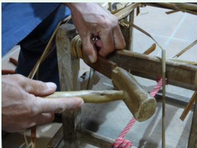
6. A mesura que anem fent s'ha d'ajustar l'embarcat amb la maça i l'escarpra perquè no s'afluixi.
