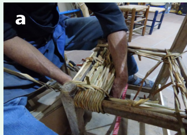
7. En aquest cas li donarem la forma anomenada «en davantal»: la part de davant és més llarga que la de darrere, així el seient serà més còmode i valent. Per aconseguir-ho, a la part de davant passarem cordill travesser cada quatre passades (a). A la de darrere, en canvi, ho farem a cada passada (b).
