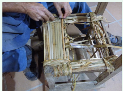
8. Per fer el seient més molsut i resistent, s'encoixina. Es tallen fulles de balca a mesura que es van encabint, amb l'ajuda del ganivet, a l'espai que hi ha entre la part de sobre i la de sota; mentre l'anem entrant per sobre del barrot i el fem sortir per sota, el cordill deixa aquest espai, que cal omplir.
