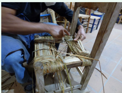
8. Per fer el seient més molsut i resistent, s'encoixina. Es tallen fulles de balca a mesura que es van encabint, amb l'ajuda del ganivet, a l'espai que hi ha entre la part de sobre i la de sota; mentre l'anem entrant per sobre del barrot i el fem sortir per sota, el cordill deixa aquest espai, que cal omplir.
