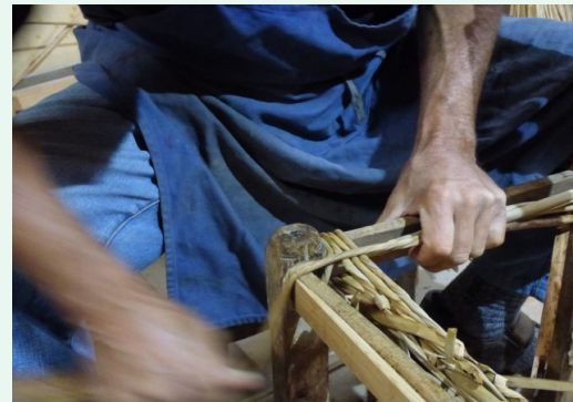
5. Es va passant el cordill d'esquerra a dreta girant la cadira, sempre entrant-lo per sobre i fent-lo sortir per sota. Cal mantenir una certa tensió al cordill perquè no s'afluixi
