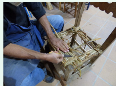
8. Per fer el seient més molsut i resistent, s'encoixina. Es tallen fulles de balca a mesura que es van encabint, amb l'ajuda del ganivet, a l'espai que hi ha entre la part de sobre i la de sota; mentre l'anem entrant per sobre del barrot i el fem sortir per sota, el cordill deixa aquest espai, que cal omplir.
