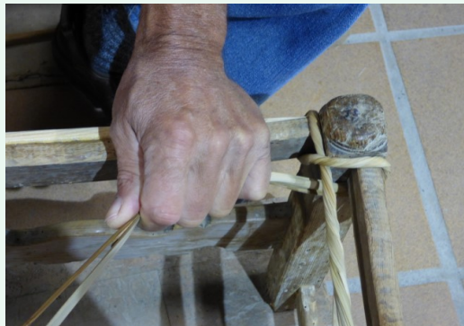
5. Es va passant el cordill d'esquerra a dreta girant la cadira, sempre entrant-lo per sobre i fent-lo sortir per sota. Cal mantenir una certa tensió al cordill perquè no s'afluixi
