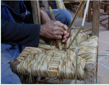
9. Es van fent passades i cap al final queda un espai molt petit on el punxó gruixut ens ajuda a fer les últimes passades.
