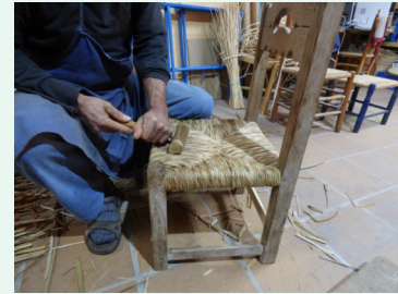
12. Llavors s'acaba pentinant els fils per sobre amb el punxó (a) i planxant-los amb la maça (b).
