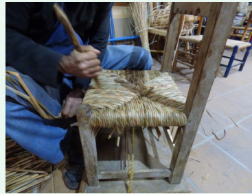
9. Es van fent passades i cap al final queda un espai molt petit on el punxó gruixut ens ajuda a fer les últimes passades.
