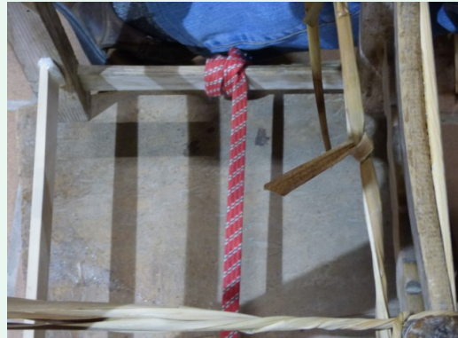
4. Quan s'acaba una fulla se n'hi afegeix una altra per tal de mantenir sempre el mateix gruix de cordill.
