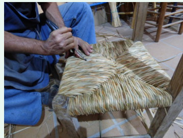
12. Llavors s'acaba pentinant els fils per sobre amb el punxó (a) i planxant-los amb la maça (b).
